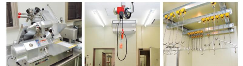
1\_ブロック肉をスライスするミートスライサー。2\_個体を吊り下げた状態で皮はぎなどの解体を行う1次処理室。3\_肉をフックにかけて熟成させる熟成庫
